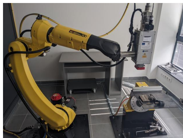
Фиг. 2. Позиционираща система за повърхностна обработка на сложни 3Д повърхнини
