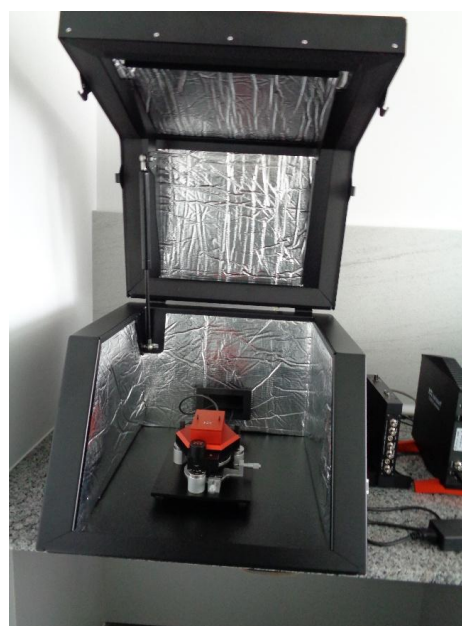
Фиг.4. Атомен силов микроскоп FlexAFM на фирмата Nanosurf
