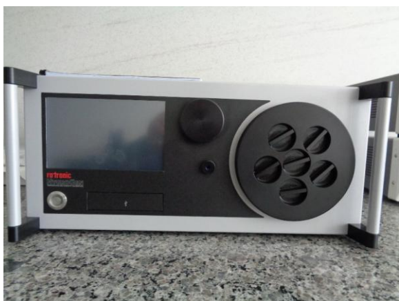
Фиг. 3. Калибратор за относителна влажност и температура HygroGen2-S
