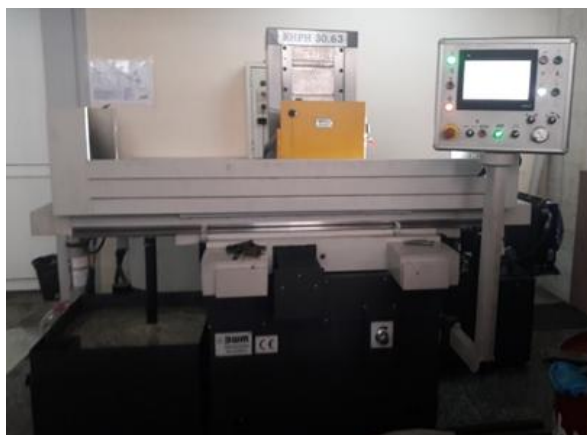
Фиг. 6. Плоскошлифовъчна машина SHPH 30.63
