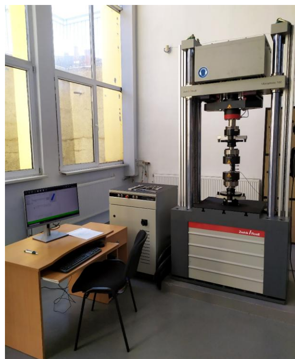
Фиг. 1. Общ изглед на комбинирана машина за статични и динамични изпитвания Zwick/Roell Vibrophore 100
