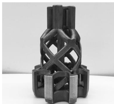
Фиг. 8. Адитивно произведен метчик с 90% намаление на масата [8]
