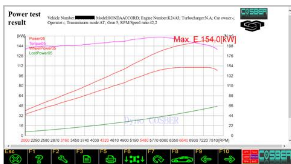
Фиг. 7. Мощностна характеристика на лекия автомобил и външната честотна характеристика на двигателя
