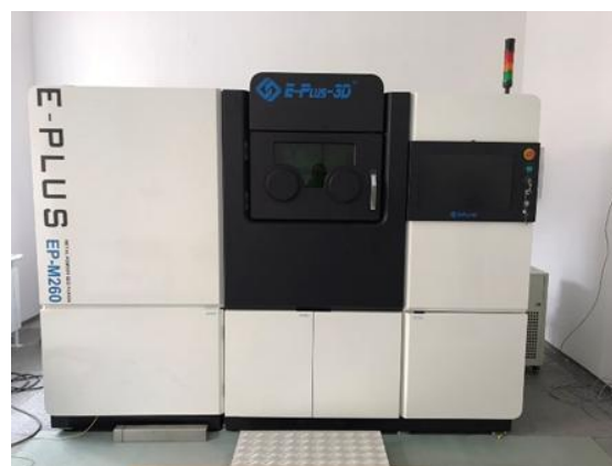
Фиг. 5. 3D принтер за метали EP-M260
