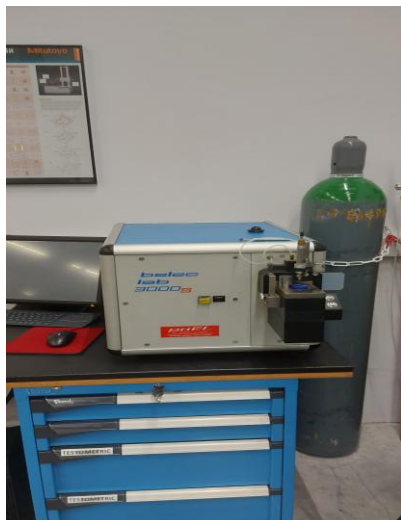
Фиг. 1. Спектрометър BELEG LAB 3000s
