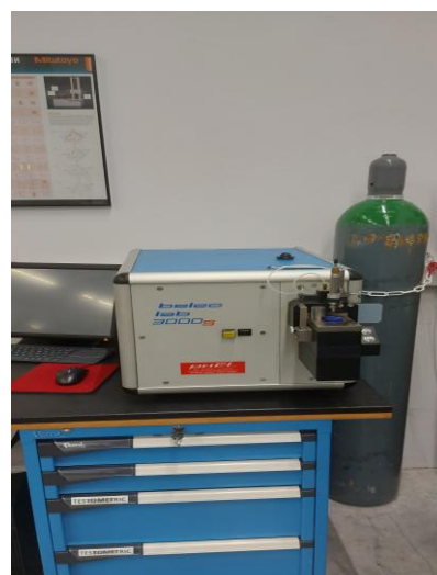
Фиг. 1. Спектрометър BELEG LAB 3000s
