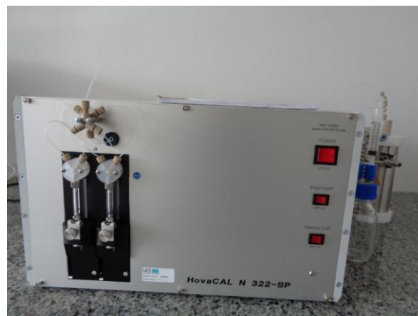
Фиг.6. Калибратор за газове и органични летливи съединения HovaCAL N 322-SP
