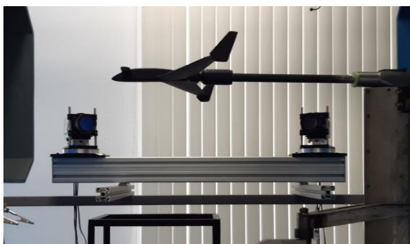
Фиг. 11 БЛА монтиран на \alpha - \beta механизма
