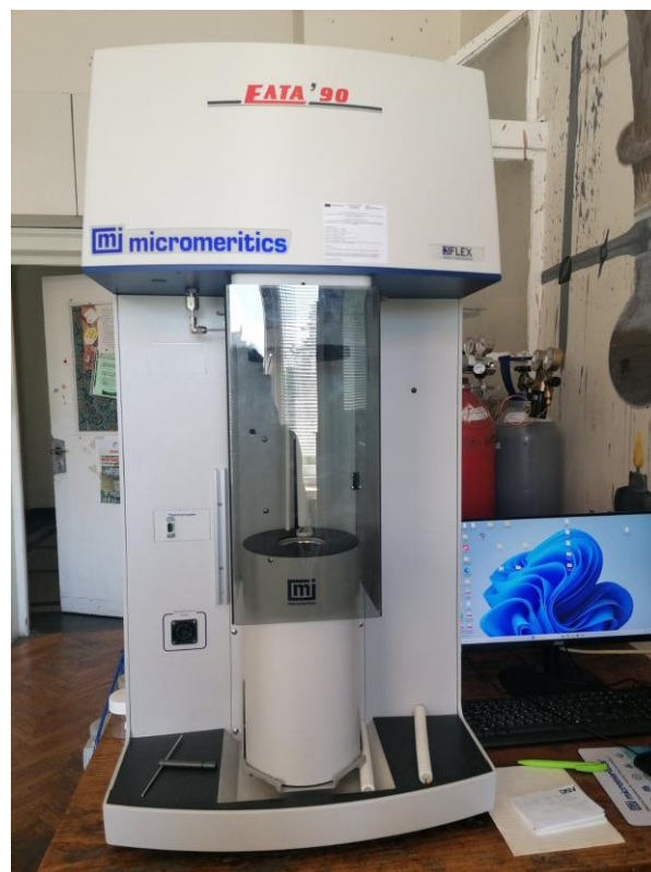
Фиг. 7. ВЕТ анализатор Micromeritics 3Flex
