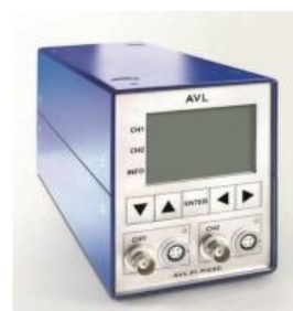
Фиг. 4. Сензор за измерване на налягането на работното вещество в цилиндъра на ДВГ – „AVL ZL45“ и комбиниран усилвател с преобразувател на сигнала от сензора – „AVL FI PIEZO, Type 2P2E“
