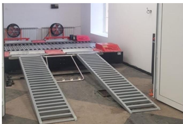
Фиг.1. Динамометричен стенд COSBER 4000
