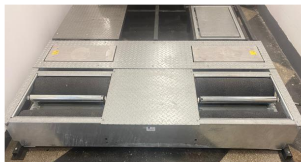
Фиг. 3. Спирачен тестер “BEISSBARTH BD640” и тестер за окачването “BEISSBARTH SA640”
