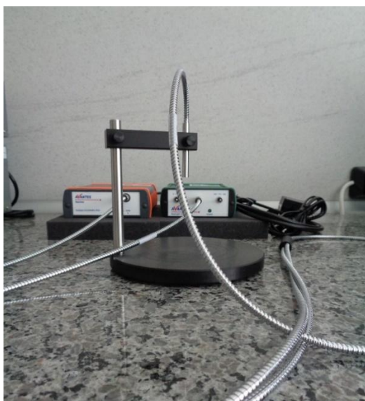
Фиг.7. Система за измерване на дебелината на тънки слоеве Avantes
