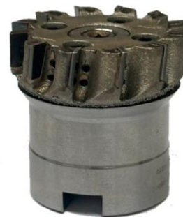
Фиг. 3. Адитивно изработено тяло на фрезен инструмент, монтирано върху държач [2]
