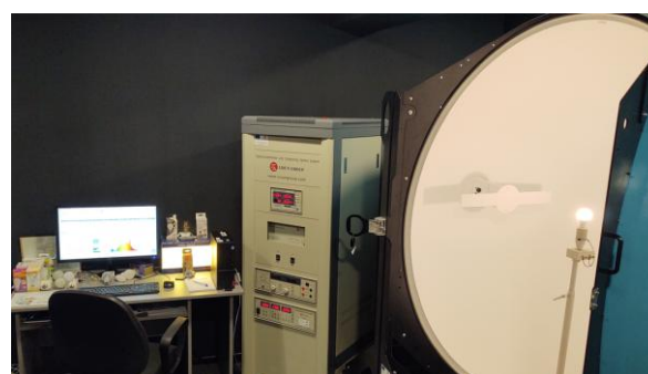
Фиг. 4. Светлотехнически измервания на лампи и осветители със спектрорадиометър LMS-9000B и сфера, тип 4 \pi , с диаметър 2 m
