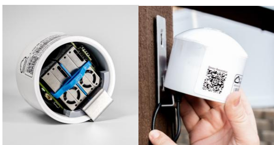
Фиг. 1. Външен вид на PurpleAir PA-FLEX-II. Забелязват се двата сензора PMS6003.
