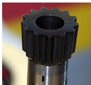
Фиг. 6. Адитивно произведен инструмент за нарязване на зъбни козела с вътрешни зъби [4]
