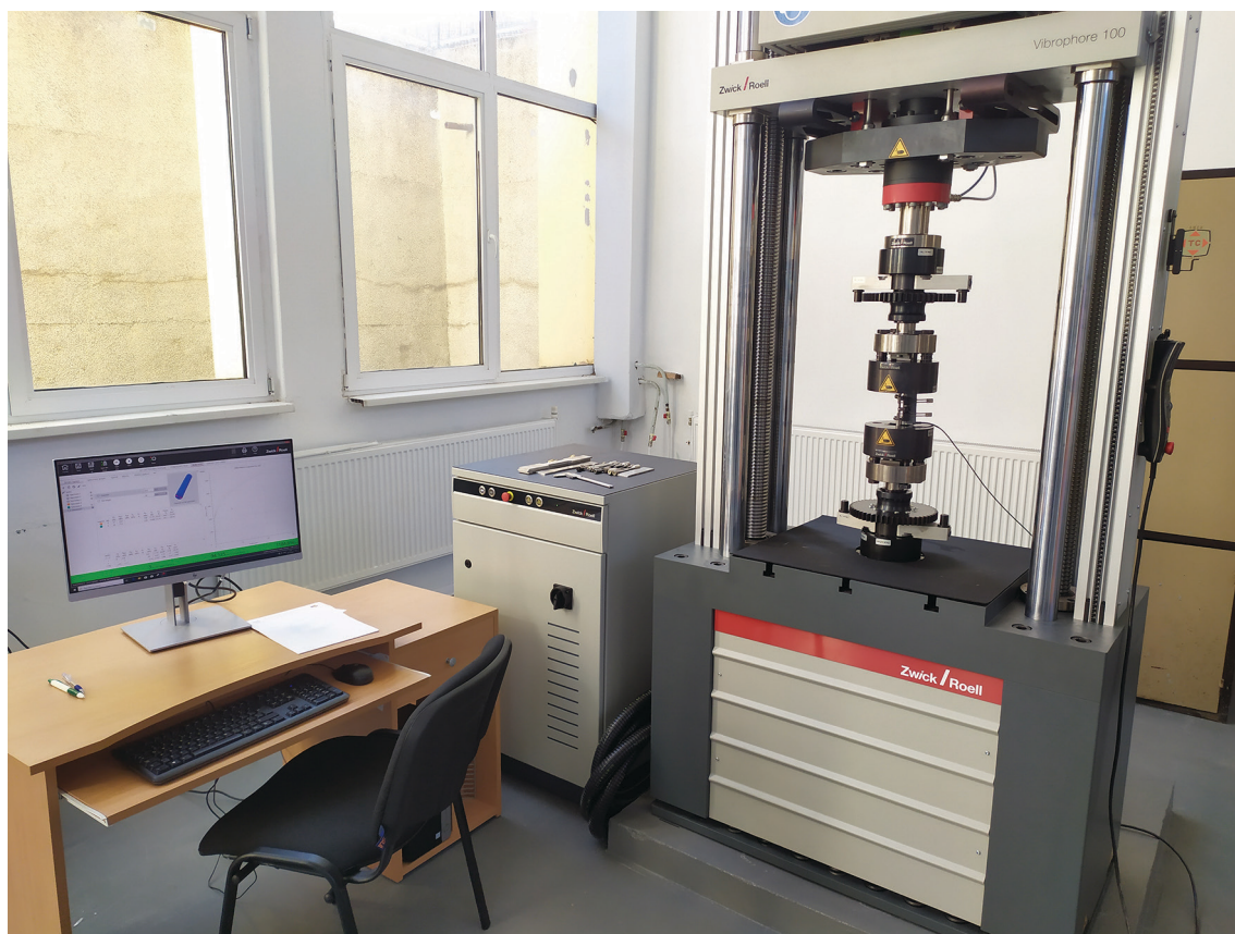
Фиг.2. Машина за статични и динамични изследвания ZWICK/Roell Vibrophore 100
