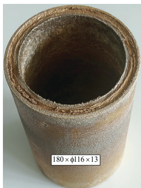
Фиг. 2. Цилиндрична втулка за изработване на пробни тела за изпитване на механичните характеристики
