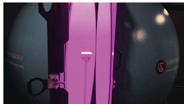
Фиг. 11. Измерване на спектрално разпределение на оранжев LED осветител
