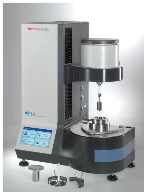
Фиг. 2. Експериментална постановка за измерване на вискозитета.
