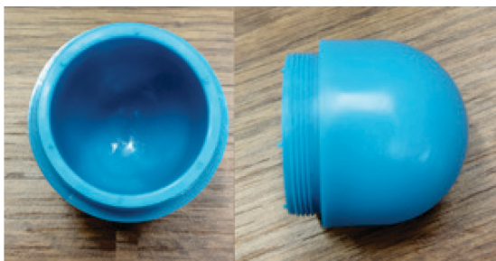
Фиг. 7. Детайл от РС, произведен чрез инжекционно формоване с шприцформа със специална temperираща система
