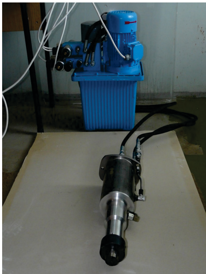
Фиг. 4 Устройство и инструмент за реализация на модифицирания процес на СР
